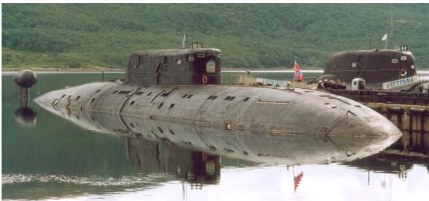
Рис. 103. Титановые корпуса подводных лодок проектов 945 «Барракуда» и 945А «Кондор»
